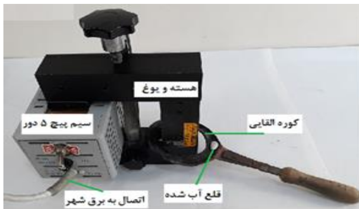
شکل (۱۱): کوره القایی. سیم پیچ ثانویه یک دور است.
